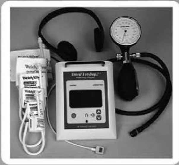
เครื่องวัดความดันโลหิต ชนิด Ultrasound Doppler Vmed Vet-Dop 2 Doppler
