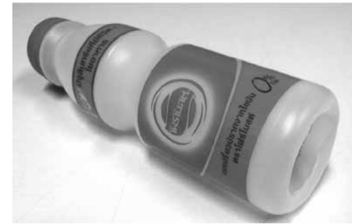
รูปที่ 3 ขวดนมเปล่า ตราไฟร์โมสต์ ขนาด 400 ml. ที่ตัดส่วนกันขวดออก โดยคงเหลือส่วนสันของกันขวดไว้
